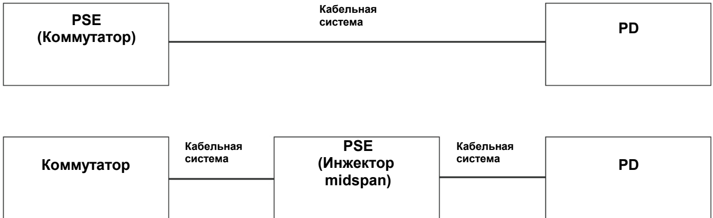
Рисунок 1. Схема организации PoE с обозначениями
